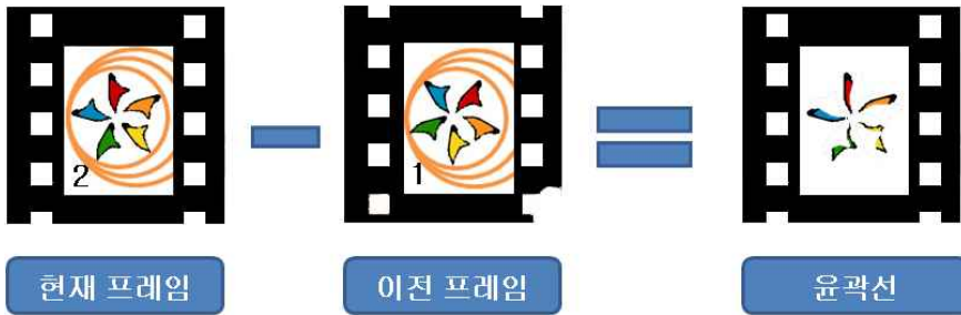
[그림-24] 프레임 차의 기본 원리
